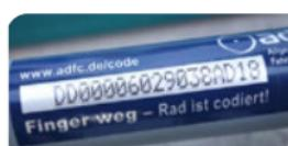
Bei der Codierung wird die Codierummer an gut sichtbarer Stelle in den Fahrradrahmen eingraviert, und mit einem Schutzaufkleber markiert.
