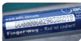
Bei der Codierung wird die Codiernummer an gut sichtbarer Stelle in den Fahrradrahmen eingefräst, und mit einem Schutzaufkleber markiert.
